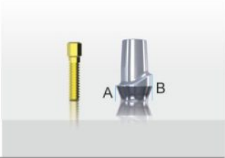
PILAR ESTÉTICO ANATÓMICO Ø 3,3 - 4 - 5. Altura A: 1,7 mm Altura B: 3 mm Incluye tornillo de Titanio con punzonado 0,48
